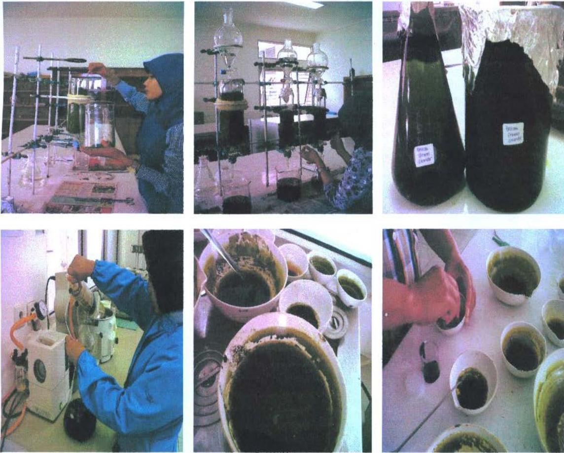
Gambar 3. Proses Ekstraksi Dengan Metode Perkolasi
