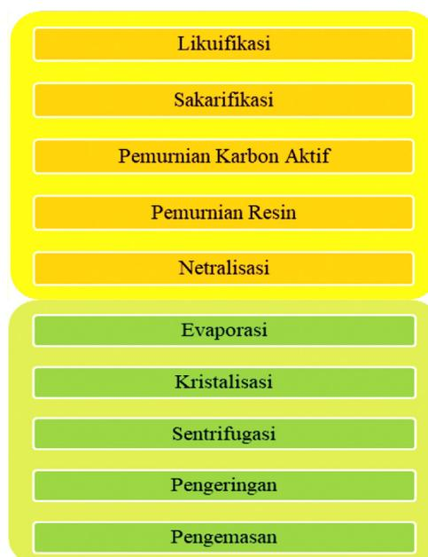
Gambar 5. Tahapan Proses Produksi DMH Farmasi
