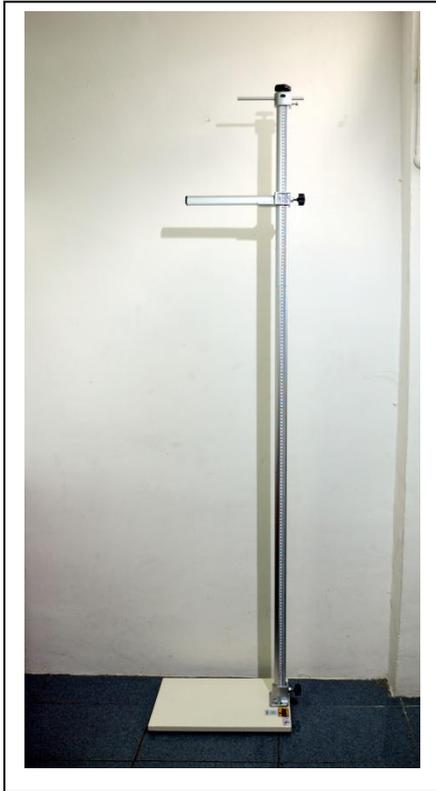
Sesuaikan alat tumpuan pada bagian atas batang ukur dengan posisi pengunci plat agar batang ukur tetap tegak lurus
