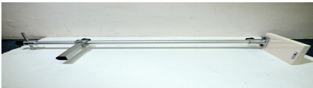
Baringkan alat ukur di meja/ lantai yang keras dan rata. Pasang panel bagian kepala pada batang dengan skala terendah dan kencangkan. Pasang pengunci dan penyangga pada ujung yang lain. Penyangga ini berfungsi agar alat geser dapat dengan mudah digerakkan tanpa bergesekan dengan meja/ lantai. Hasil pengukuran ditunjukkan oleh garis pada jendela baca. **Pembacaan dari angka yang kecil ke arah angka yang lebih besar.**
