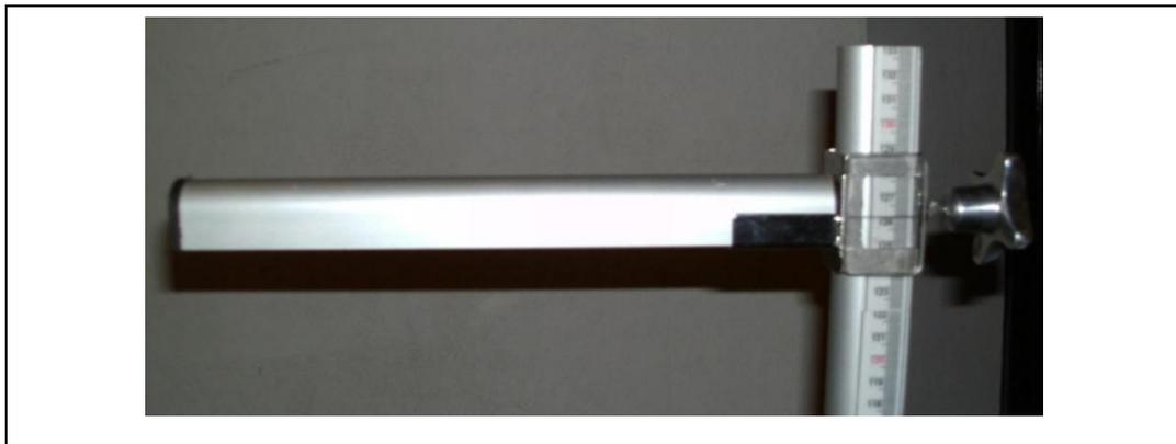
4. Pasang alat geser dengan cara memasukkan alat geser ke batang alat ukur. Perhatikan posisi kaca baca harus berada pada skala ukur.
