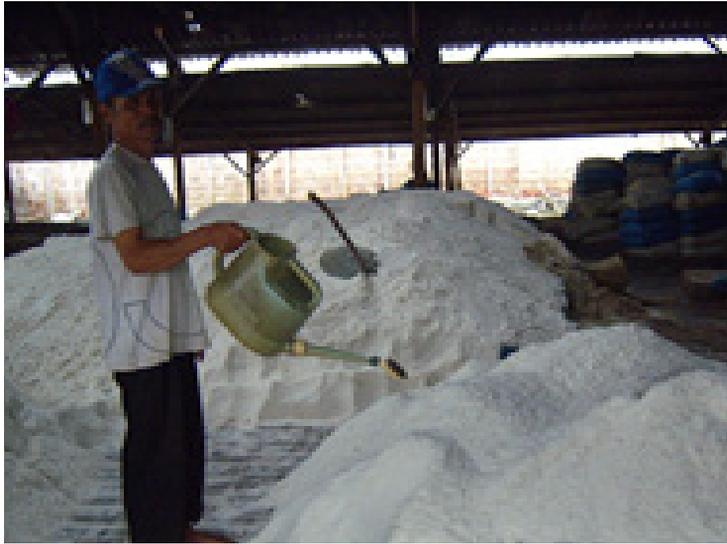
**Gambar 2.1** Proses iodisasi garam sederhana
