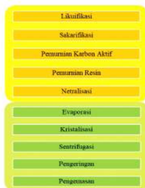
Gambar 5. Tahapan Proses Produksi DMH Farmasi
